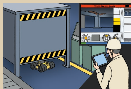
工場設備狭隘・危険箇所点検作業支援 (構造物・敷設物劣化点検)
