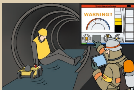
トンネルなどの閉塞空間におけるレスキュー作業支援 (ガス・酸素濃度測定、酸素補給、音声通信)
